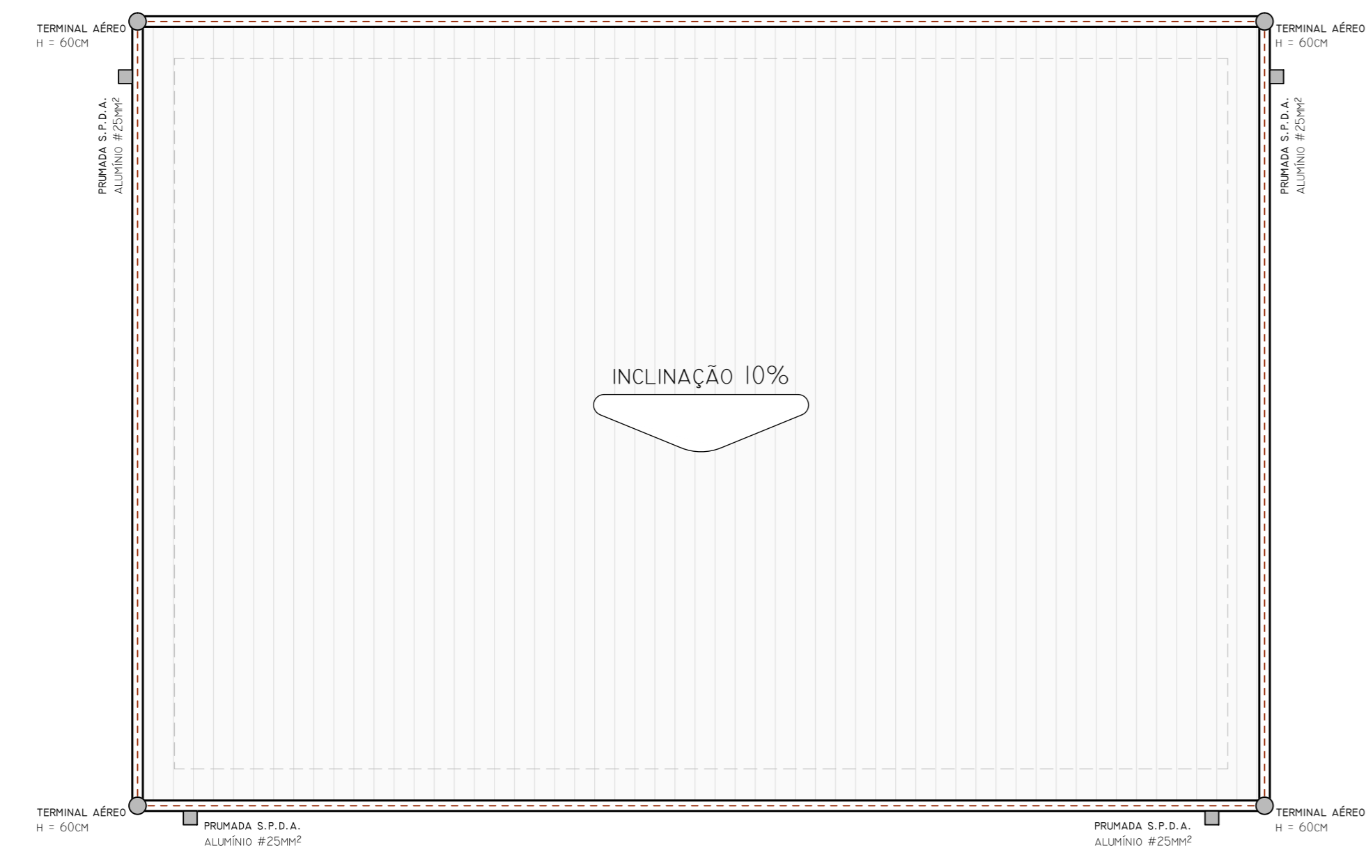
09 PLANTA DE COBERTURA SUBESTAÇÃO ESCALA 1:50
